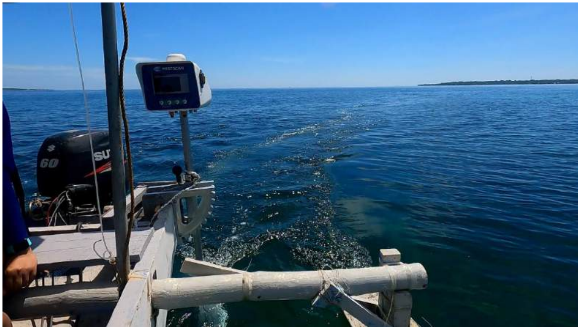
Hình 7. Thiết bị ReefScan khi gắn trên tàu để chạy chụp hình ảnh rạn san hô dưới nước
